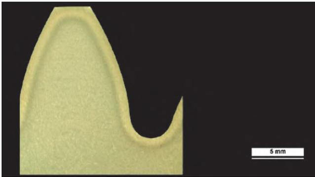
Bild 9. Übersichtsaufnahme des geätzten Schliffes eines mit dem sauerstofffreien Normaldruck-Prozess einsatzgehärteten Zahnrades aus 18CrNiMo7-6
